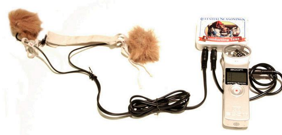
Aparells emprats per l'enregistrament d'àudio: els micròfons recoberts amb l'espuma i el protector antivent, i lligats amb la cinta flexible; l'amplificador i alimentador dels micròfons; la gravadora de so.
