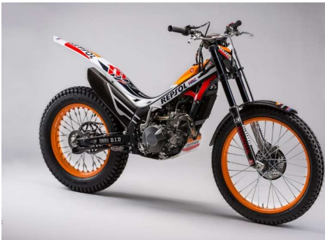
Fou la primera de la gamma equipada amb un motor de quatre temps (concretament, un de 249,1 cc monocilíndric amb refrigeració líquida i canvi de 5 velocitats).
