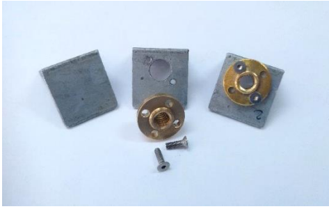
Fig.26 Muntatge del suport per la rosca
