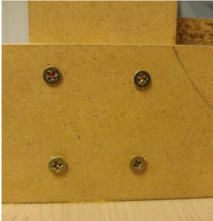
Fig.64 Fixació de la torre a la base
