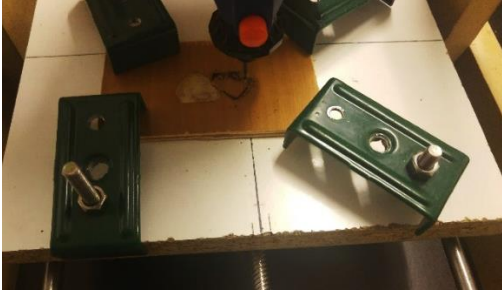
Fig.69 Fixacions del llit de fresat
