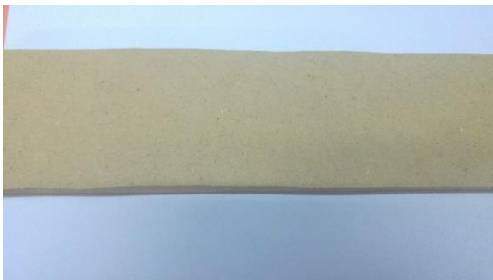
Fig.12 Peça de 70x300x18 mm que conforma un dels 4 laterals del calaix del llit de fresat
