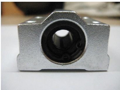
Fig.31 Interior d'un rodament lineal
