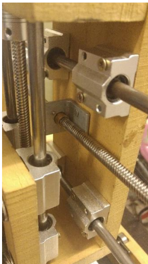
Fig.66 Fixació de la caixa de la fresadora
