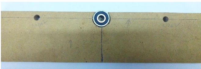
Fig.57 Acoblament del rodament rígid
