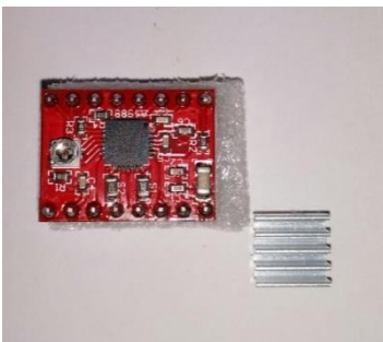
Fig.117 Xip A4988 i dissipador de calor
