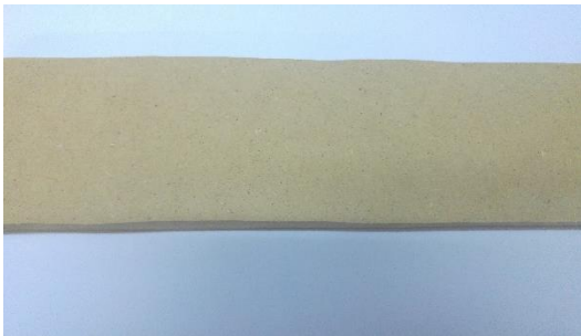
Fig. 14 Peça de 70x300x18 mm que conforma un dels 2 suports de la torre de la fresadora
