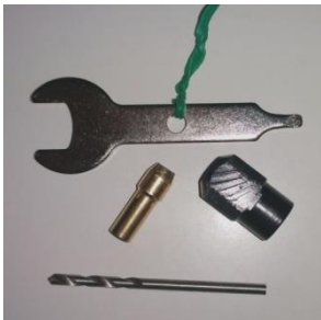
Fig.35 Peces del sistema de fixació per les fresas
