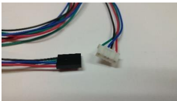
Fig.42 Connexió del motor per passos a la placa d'Arduino
