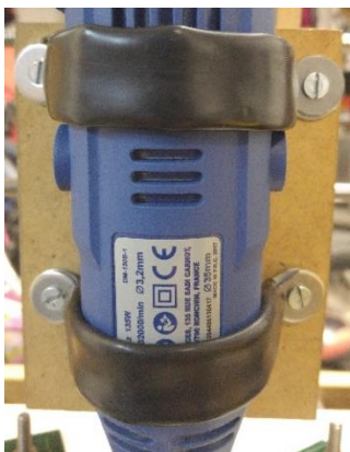
Fig.10 Detall de la fixació per a la fresadora
