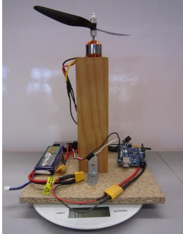
Imatge 25: Mesura de l'empenta del motor.
