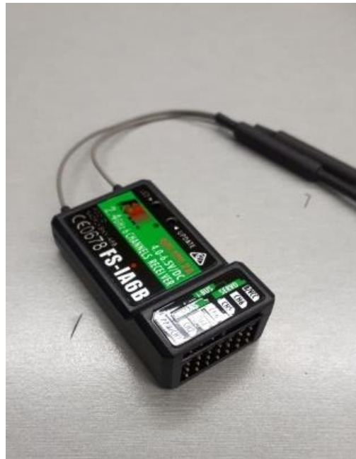
Imatge 58: Receptor definitiu amb sortides en sèrie i en paral·lel.
