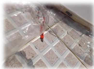
2. On prend les bouteilles et on fait deux trous dans les extrémités vers le haut de la bouteille, un trou à chaque extrémité. Après on fait les mêmes trous dans les extrémités de dessous. On répète cette action avec toutes les bouteilles.
