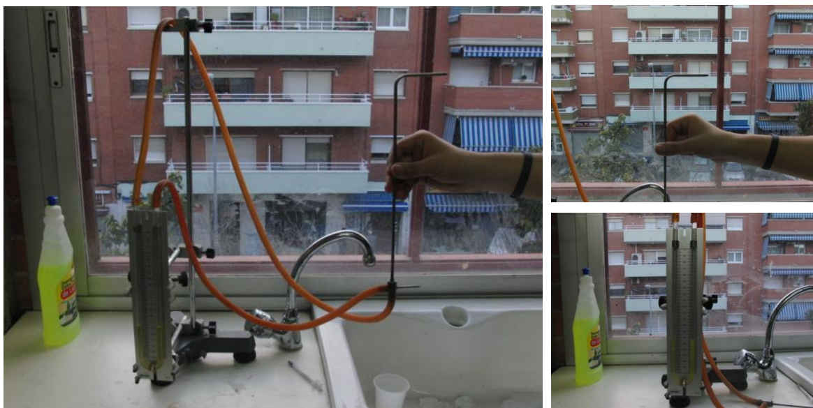
Fotografies anemòmetre i tub de Pitot
