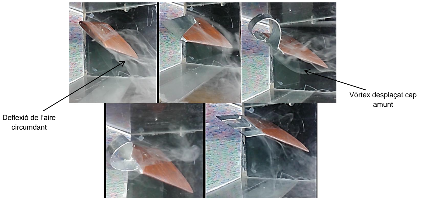
Figura 117. Trajectòria que realitzaria l'aire a través dels diferents winglets amb \alpha 40°. Ala sense winglet , Blended winglet , AFT Spiroid , FWD Spiroid i Wing-grid winglet respectivament.
