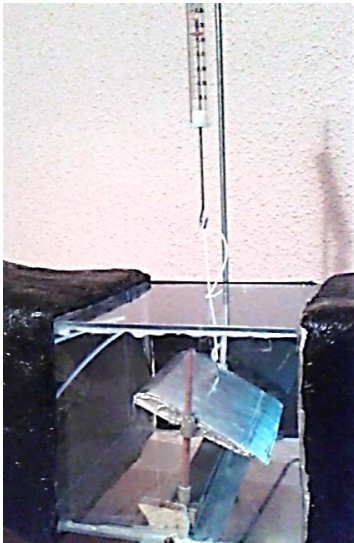
Figura 124. S'ha gravat el dinamòmetre amb càmera en tot moment per observar el desplaçament d'aquest.
