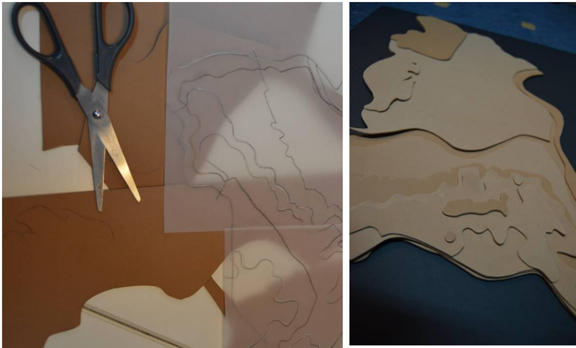
Il·lustració 81 Imatges del procés de la maqueta, tallant les corbes de nivell i enganxades.
