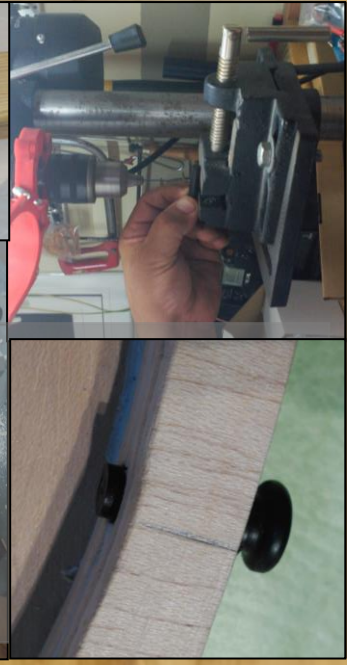
Forats del claviller, de les clavilles i del cordal.
