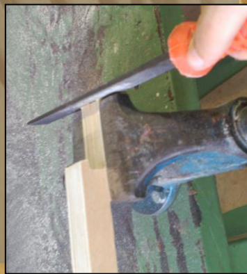
Construcció del mànec amb quatre llistons de fusta.
