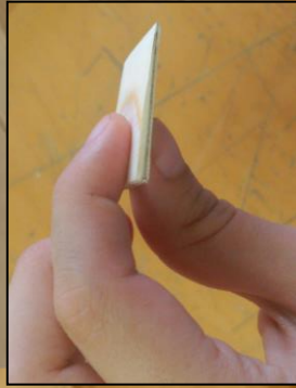
Alçament de batidor amb una petita cunya.
