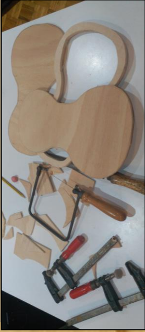
Imatge de les peces internes del violí, la tapa i el fons juntament amb les eines situades a l'esquerra: la serra de marqueteria i els sergents.
