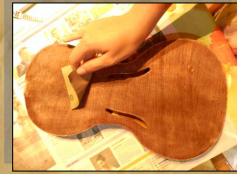
Polint la fusta per a posar una altre capa de vernís.
