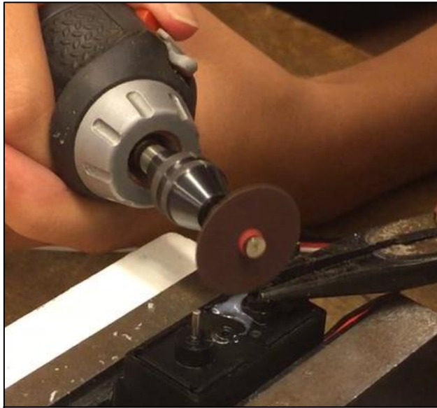
Figura 4. Procés de modificació del potenciòmetre del servomotor.
