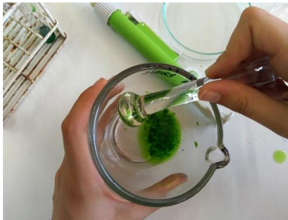
Figura 7.11: Trituració de una mostra de fulles amb etanol per fer l'extracció de clorofil·la
