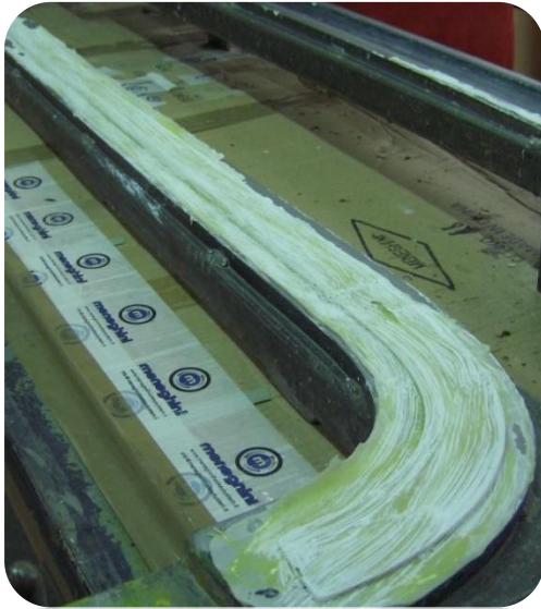
Resultat de la primera part del procés un cop extret del motlle al cap de 5 hores
