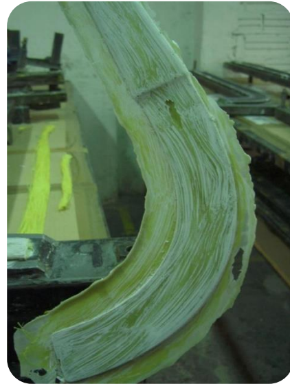
Resultat de la primera part del procés un cop extret del motlle al cap de 5 hores
