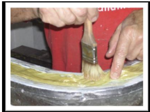
Reforçant la part de la pala amb doble capa de kevlar
