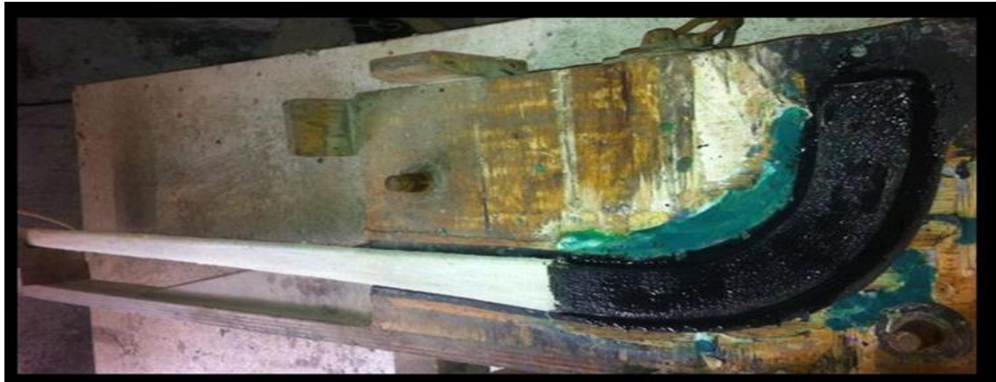
Estic amb la pala coberta de pintura i resina sense assecar
