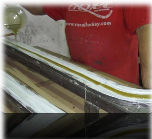
Motlle omplert de resina
