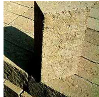
Figura 11: Bloc massís de calç hidràulica
