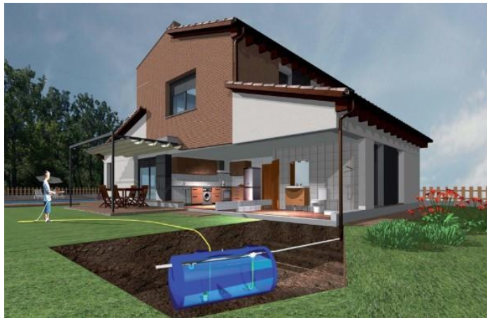
Figura 43: Dipòsit recol·lector d'aigües pluvials.
