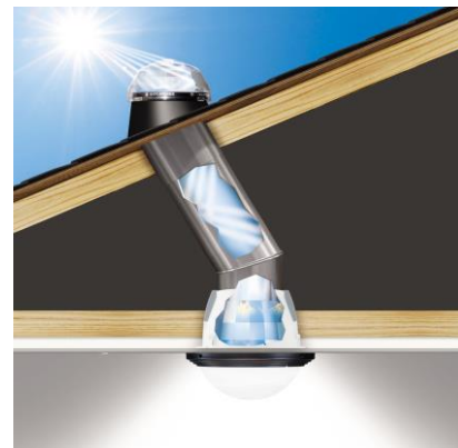
Figura 47: Sistema de tub solar
