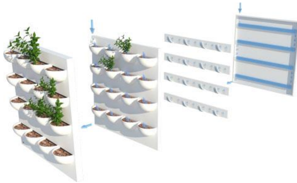
Figura 27: sistema hidropònic en parets vegetals.
