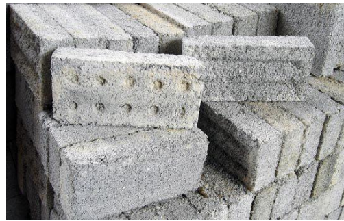
Figura 9: Blocs de formigó amb additius de plàstic reciclat
