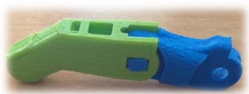
Il·lustració 30: Un dit muntat. S'observa la peça d'unificació de color blau a la zona verda.
