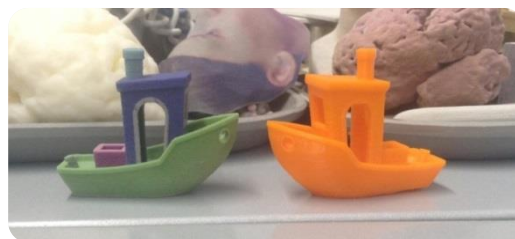
Il·lustració 9: Tenim un vaixell imprès en diferents mètodes. A la dreta trobem el vaixell imprès per una impressora FDM mentre que a l'esquerra per el mètode SLS.
