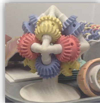
Il·lustració 12: Peça impresa en una sola impressió pel mètode SLS. Les peces petites de colors tenen una certa mobilitat.
