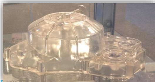
Il·lustració 11: Disseny d'una base d'investigació transparent impresa pel mètode SLA
