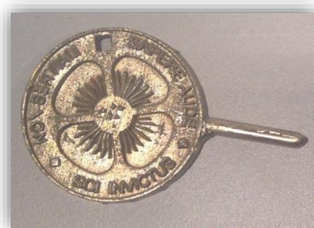
Il·lustració 19: Joia metàl·lica impresa per mètode SLA amb dibuixos i lletres
