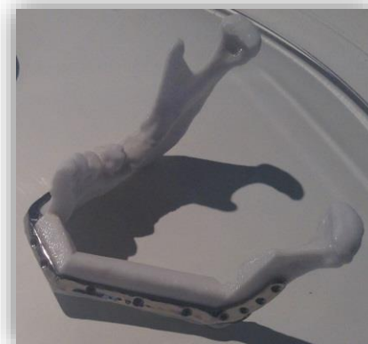
Il·lustració 15. Mandíbula impresa en titani per la empresa Renishaw.
