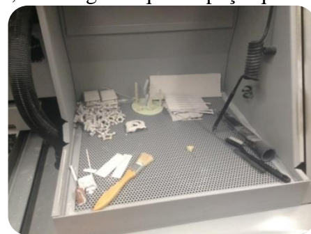
Il·lustració 8: Zona de post-tractament de la impressora ZPrinter 450 per tal de netejar la pols restant de les peces acabades de imprimir.
