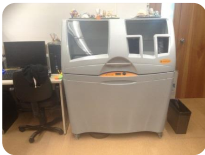
Il·lustració 4: ZPrinter 450 és una impressora SLS que imprimeix en pols ceràmic.
