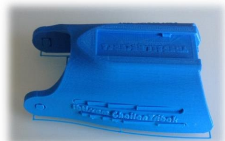
Il·lustració 23: El guantlet acabat d'imprimir . S'observen els textos inserits.
