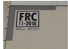
Placa ATP que identifica un frigorífic reforçat classe C, amb data de certificació fins a novembre de 2018.
