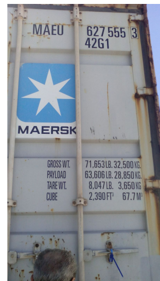
Porta d'un contenidor amb indicacions de mesures i codi del propietari
