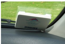
Una etiqueta RFID emprada per a la recaptació amb peatge electrònic. Font: Wikipèdia
