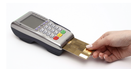
El TPV (terminal punt de venda) és un sistema informàtic o electrònic microcomputaritzat que mitjançant la lectura del microprocessador EMV (Europay MasterCard VISA) que incorporen les targetes de crèdit i dèbit, s'autentifiquen i es gestionen els pagaments de manera accessible per als venedors.
