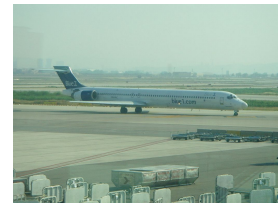
Es mostren ULD que s'adapten a la forma del fuselatge de l'avió.
