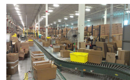
Les cintes transportadores de rodets s'utilitzen per caixes o productes d'una certa mida.
