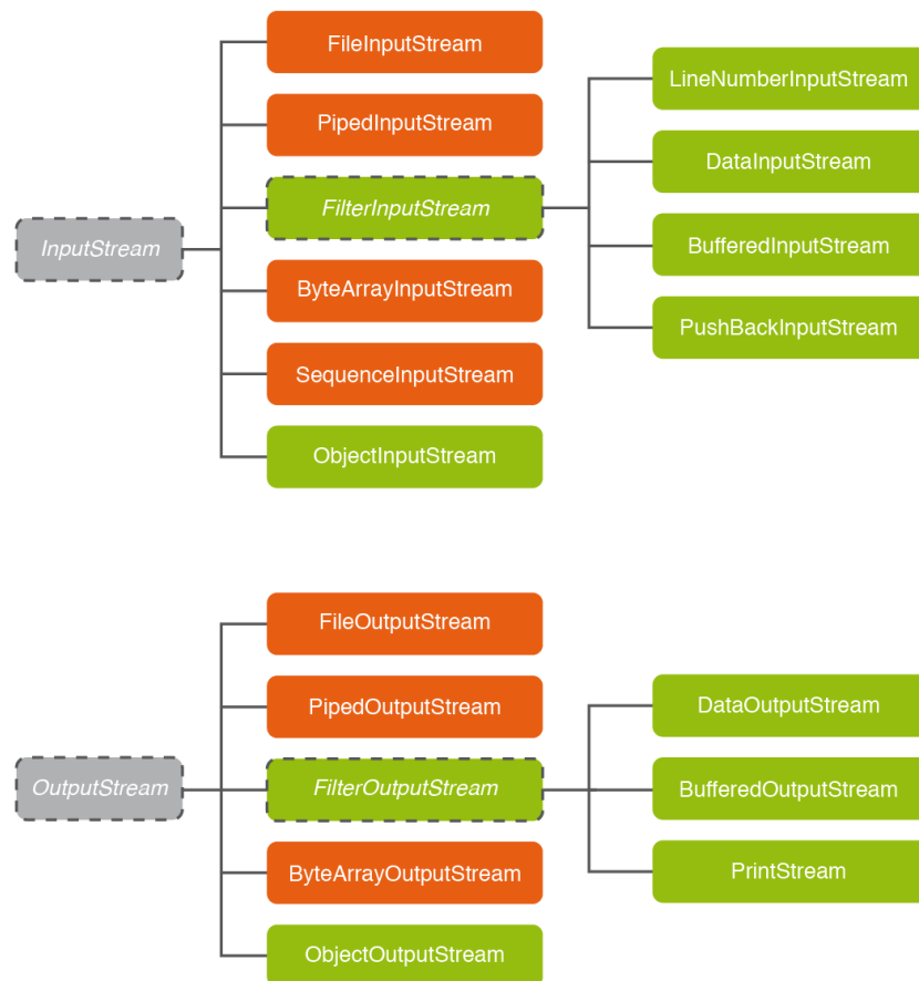
FIGURA 2.4. Jerarquia de les classes de Java que implementen fluxos orientats a bytes
