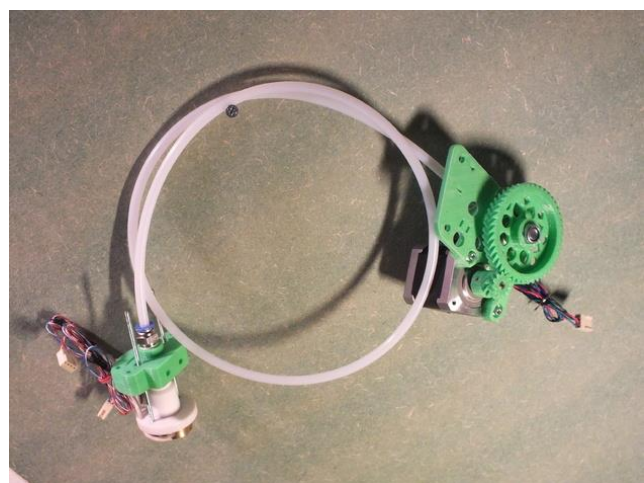
Funcionament d'un extrusor d'extrusió Bowden.
