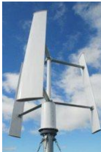
Fig. 2.3. Aerogenerador d'eix vertical Giromill.
