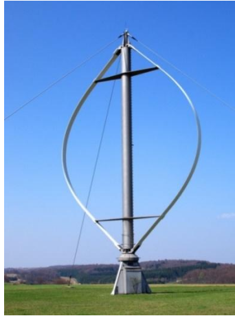
Fig. 2.2. Aerogenerador d'eix vertical Darrieus.
