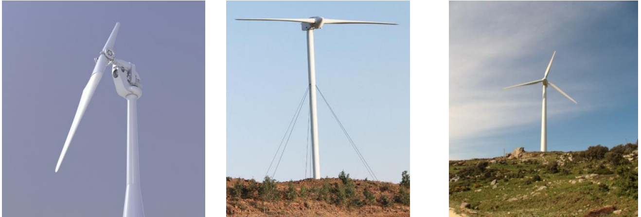
Fig. 2.5. Aerogeneradors d'eix horitzontal d'esquerra a dreta ( monopala, bipala i tripala).
