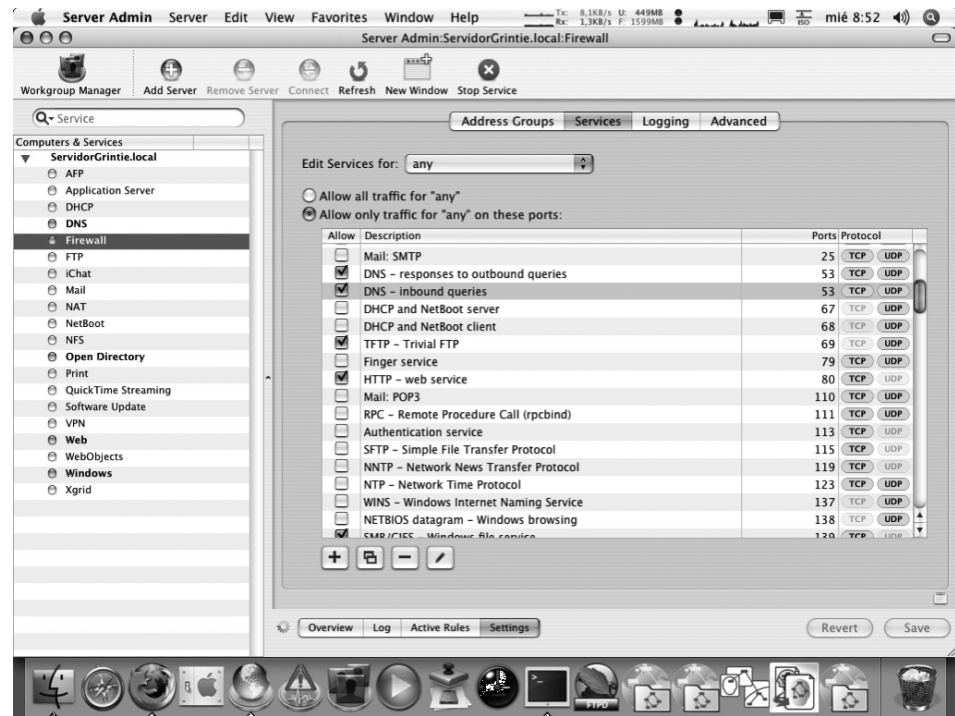
FIGURA 2.6. Configurador del tallafoc de MacOSX Server
