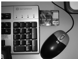
Dispositiu de lectura de targetes intel·ligents incorporat en un teclat d'ordinador.
