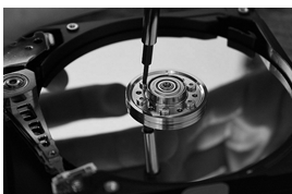
Disc dur sense la tapa protectora. Hi podem veure els plats recoberts de material magnètic i els capçals de lectura/escriptura.
