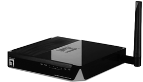
Els punts d'accés Wi-Fi són els elements que interconnecten els dispositius sense fil amb les xarxes cablades.
