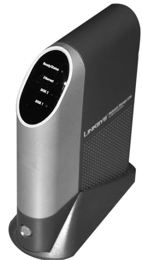
Sistema d'emmagatzematge en xarxa: conté un programari específic que permet als diferents usuaris d'aquest sistema accedir-hi mitjançant la interfície de xarxa ethernet i utilitzar l'espai d'emmagatzematge que ofereix.
