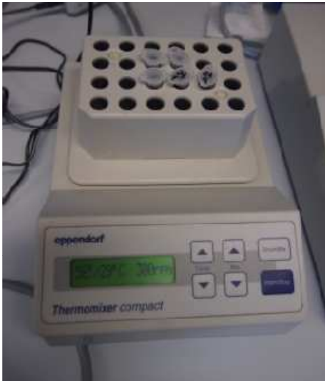
Mostres a la incubadora a 56°C i 300rpm
