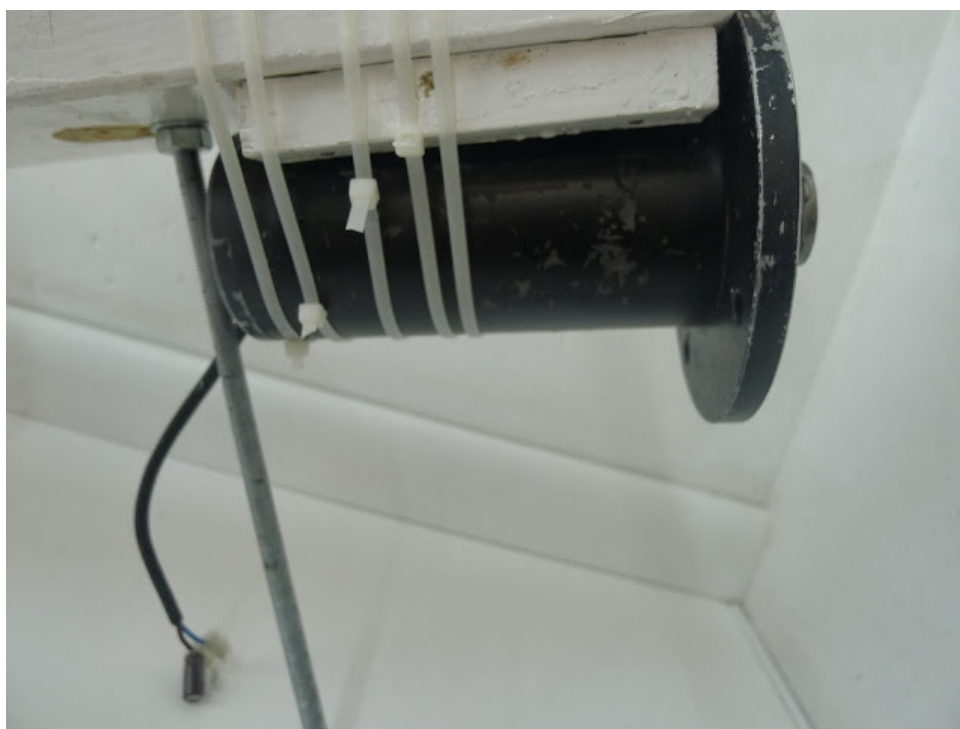
Figura 13: motor de corrent continu de 12 volts a 1500 rpm
