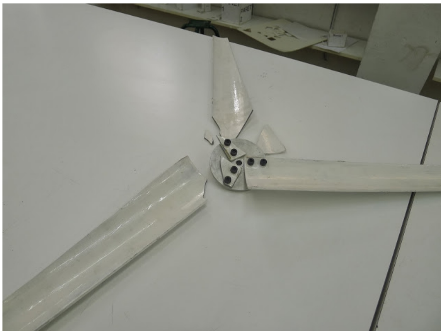
Figura 12: Boixa amb les aspes trencades que havíem de canviar
