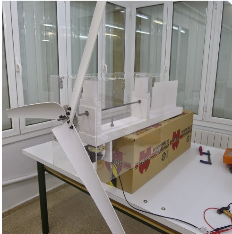
Figura 22: Resultat final de la capsa de protecció
