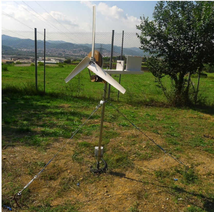
Figura 36: Resultat dels tensors instal·lats
