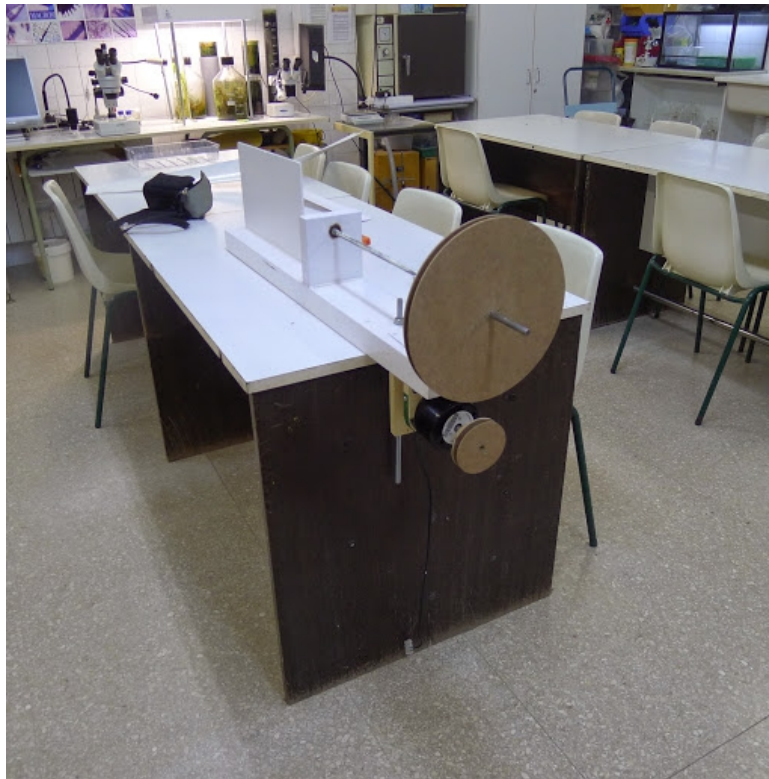
Figura 20: Politges instal·lades sense la corretja
