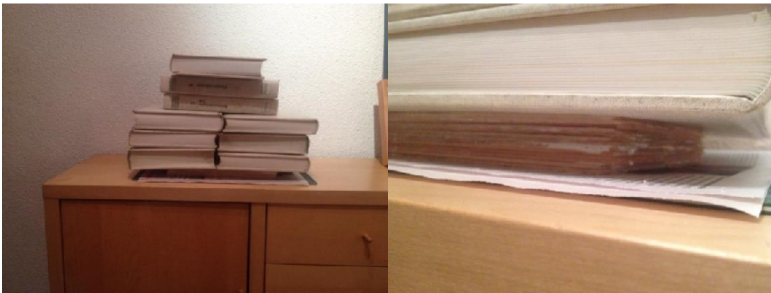
Il·lustració 35 i 36: Perquè s'assegués, vam posar molt pes a sobre de les fustes enganxades amb cola.
