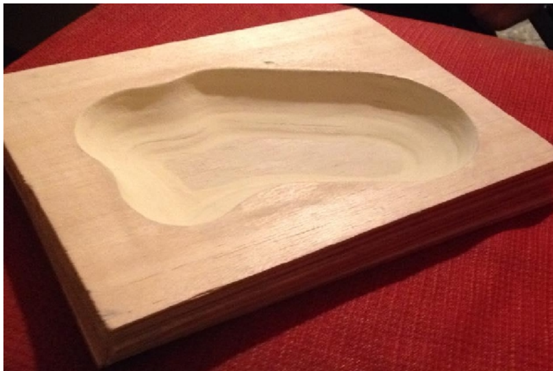
Il·lustració 31: Un cop seca la massilla, vam tornar-ho a llimar i aquest cop si que va quedar força llis, per ara pintar-ho.
