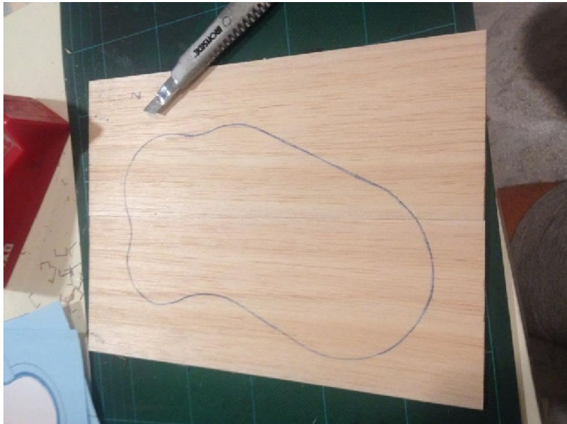
Il·lustració 33: Cada fusta de 20 cm de llarg es va unir amb una altra de manera que quedessin 14 capes de 2 fustes cada una. Amb paper de calcar, vam dibuixar a sobre de cada capa la forma del bowl restant cada cop 2mm.
