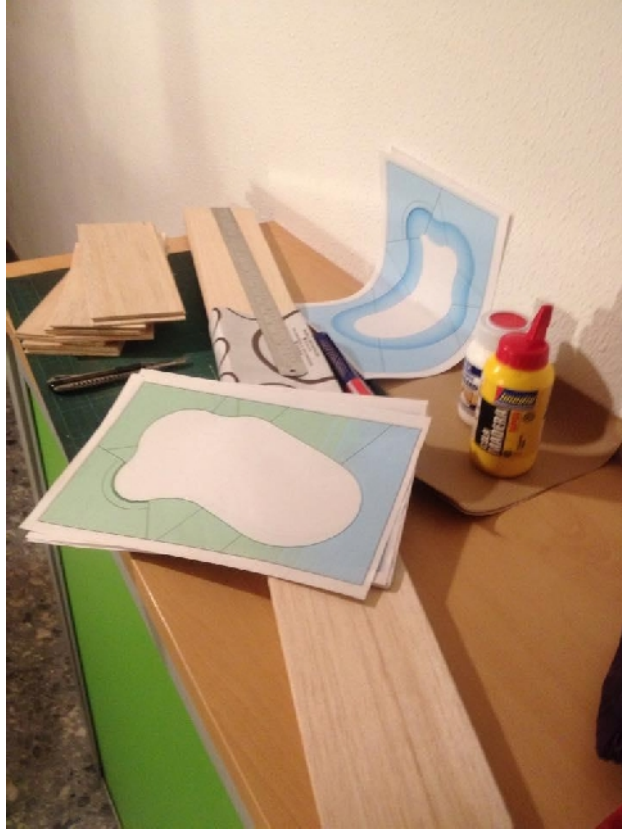
Il·lustració 32: Fustes tallades en parts de 20 cm de llarg. Per cada taula de fusta, sortien 3 fustes de 20 cm i en necessitàvem 28.
